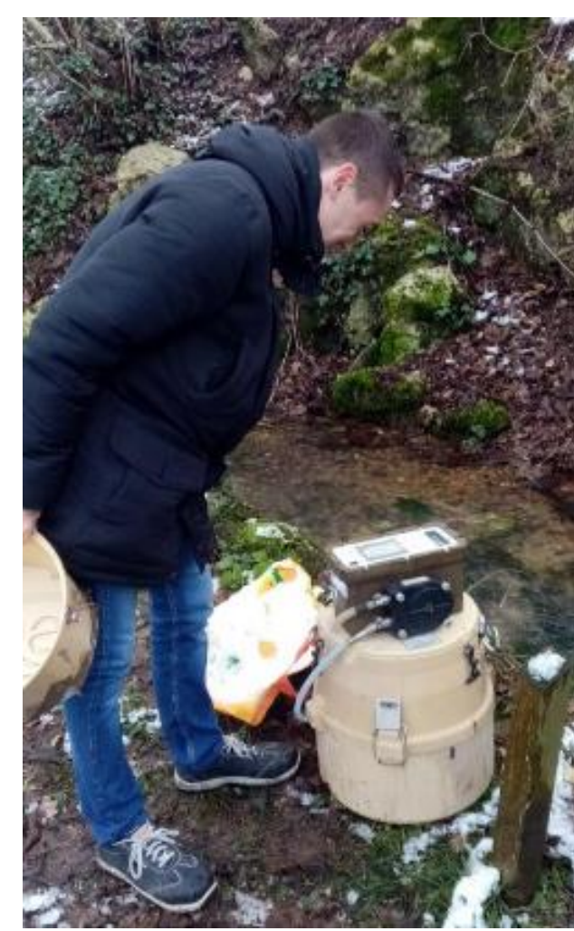
Fig. 4 : Installation du fluorimètre STREAM à l'une des sources de l'Archer.
