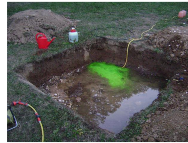
Essai de traçage pour l'évaluation de vulnérabilité d'un aquifère karstique après le décapage de la couche de couverture, Suisse
