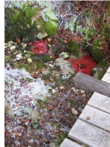
Mesure de la restitution du traceur au droit d'une source
