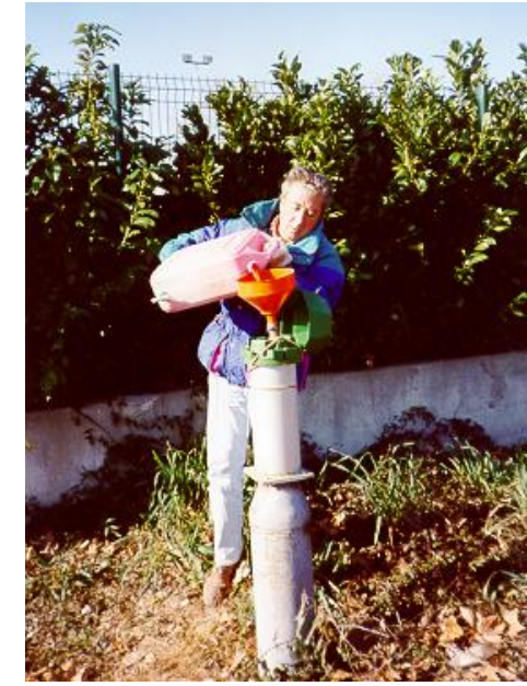
Injection d'un traceur au droit d'un piézomètre
