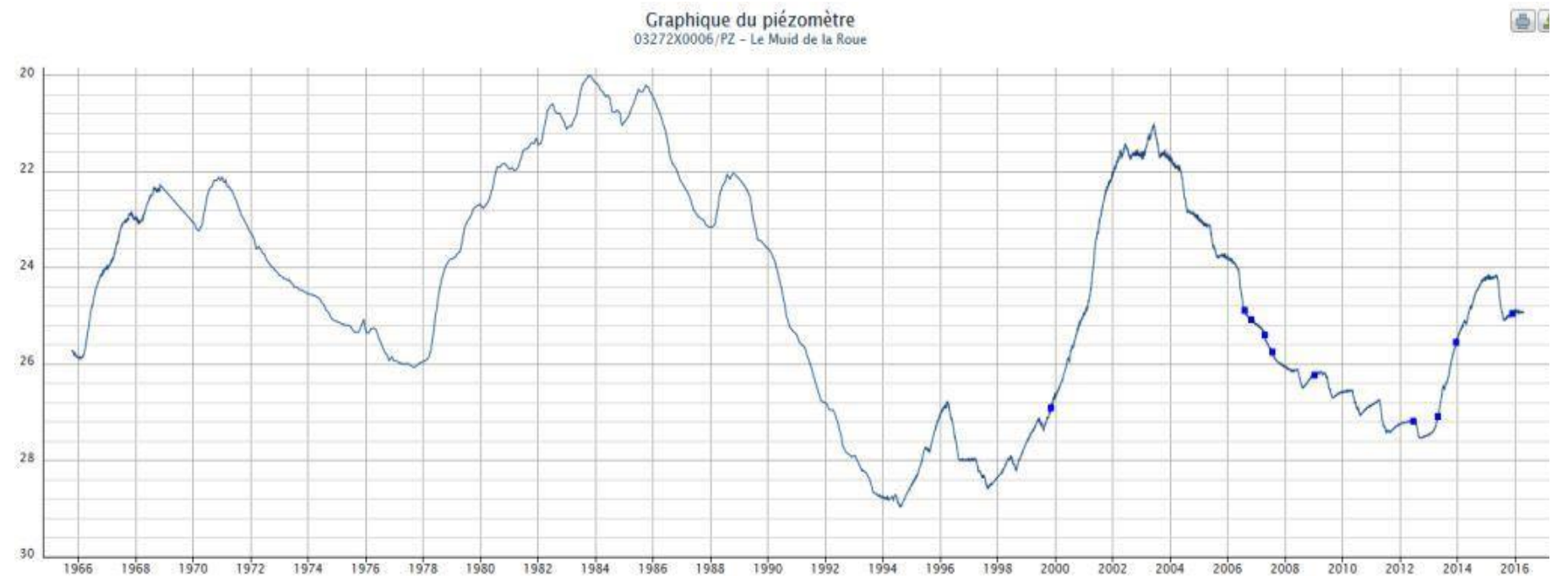
Courbe piézométrique 1978-2015 au piézomètre de Trancrainville situé en Beauce centrale (capte les calcaires de Pithiviers et les calcaires d'Etampes) – prof. en m/repère de mesure
